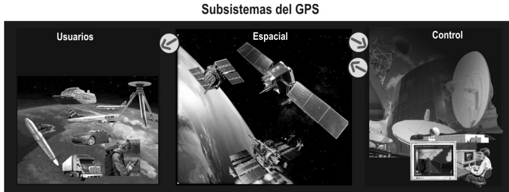
Figura 2.25 Subsistemas del GPS
