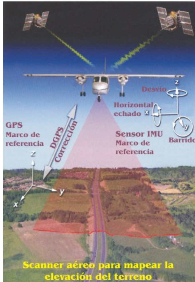
Figura 2.24 Descripción del sistema Lidar
