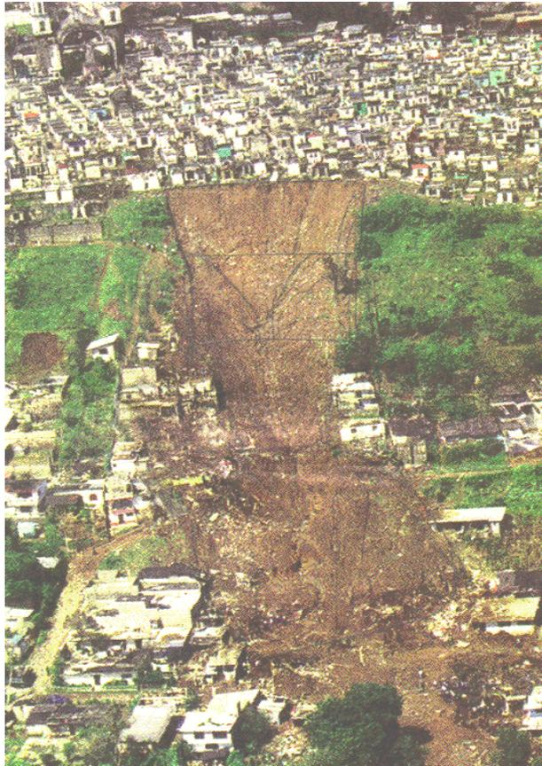
**Figura 5.16** Vista aérea del deslizamiento, en la Col. La Aurora, cuya corona abarcó una parte del panteón que se ubica en la plataforma
