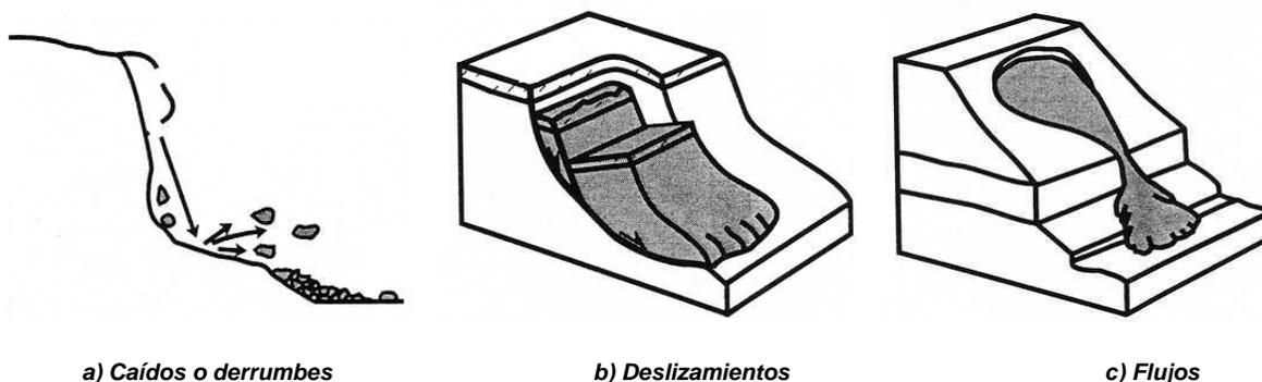
Figura 5.1 Principales tipos de deslizamientos en laderas
