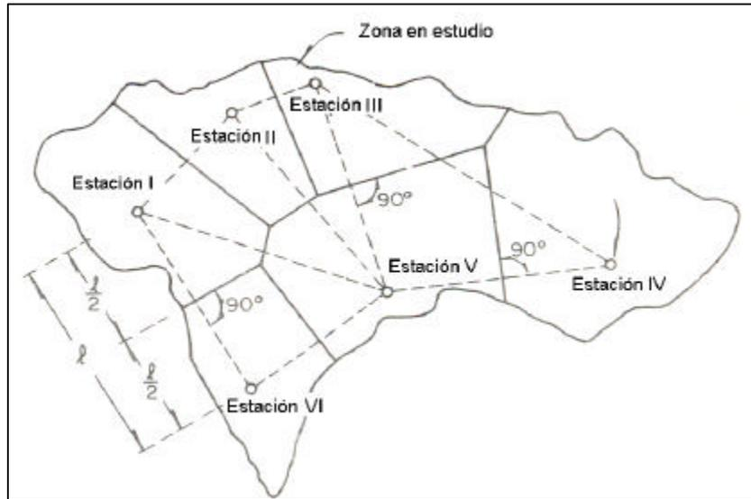
**Fig. 6.12 Diagrama que explica el método de Thiessen**
