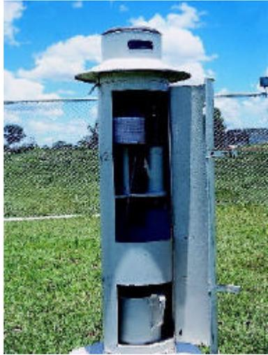
**Fig. 6.2 Pluviógrafo común con un sistema de reloj**
