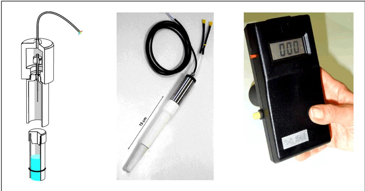
**Fig. 6.16 Tensiómetro electrónico y equipo portátil de medición**
